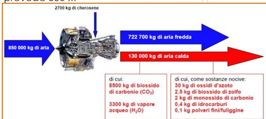
fig.1 - La combustione aperta in un reattore di aeromobile
